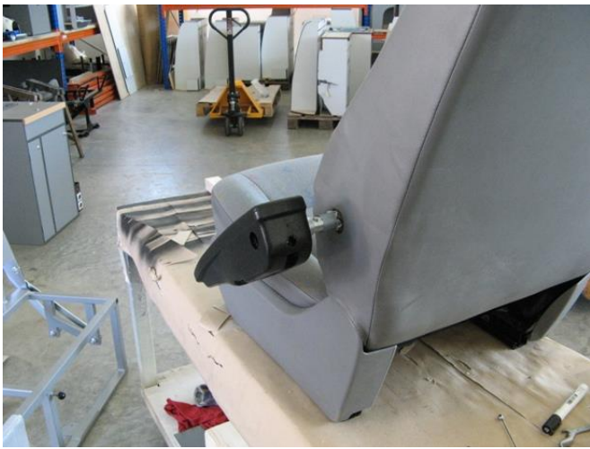
Imbus M8 x 20 von unten einführen und festziehen
