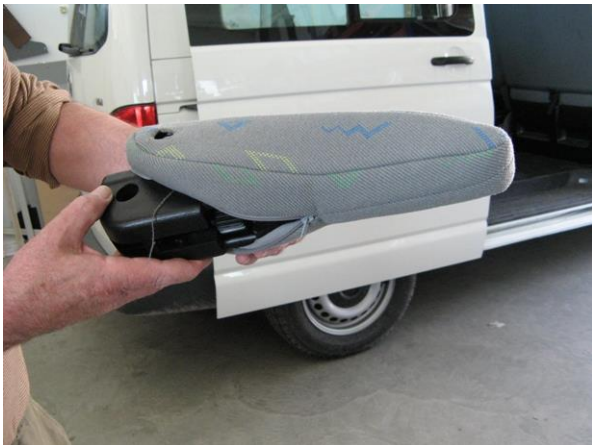
Imbus M8 x 20 von unten einführen und festziehen
