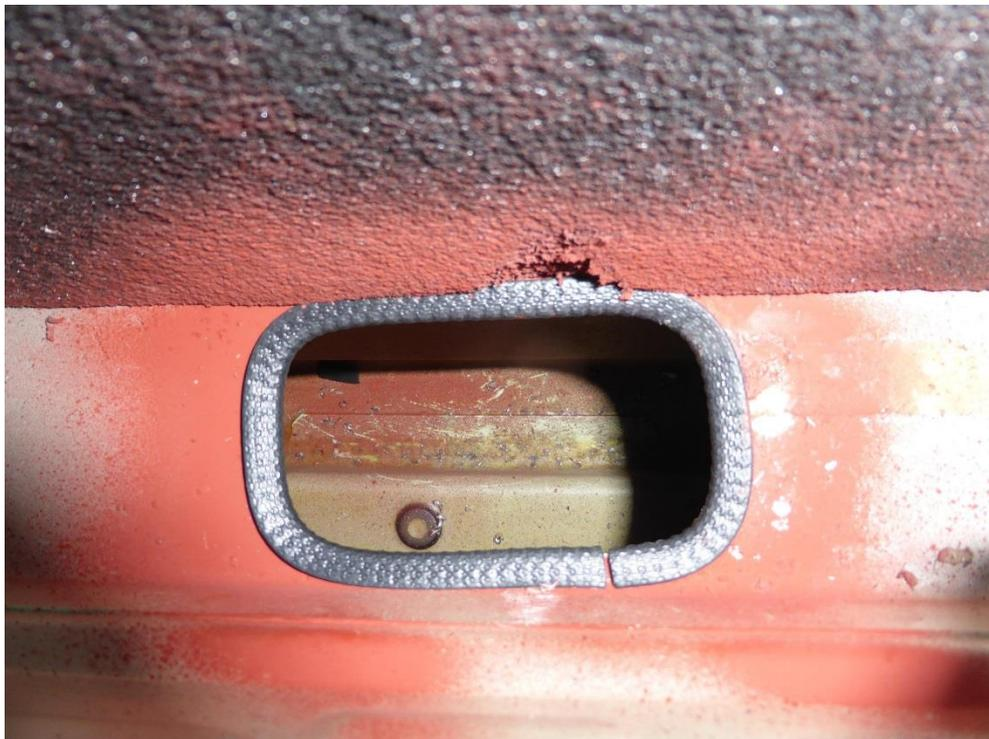
4. Originale Verkleidung am Unterboden abbauen, Verschlussstopfen entfernen und Abwasserschlauch durch Schweller zur geschlittenen Öffnung durch führen.
