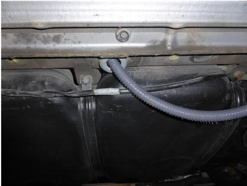
5. Abwasserschlauch am Ablauf mit Schlauchschelle befestigen
