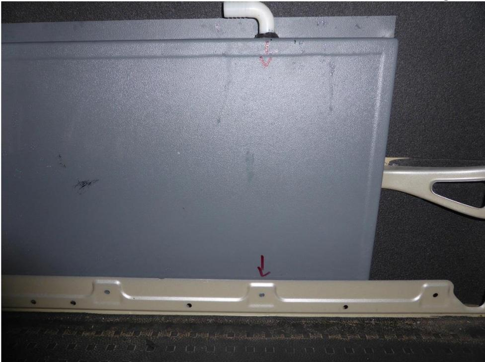
3. Markieren Sie die Position des Ablaufes am Fahrzeug und schneiden Sie mit geeignetem Werkzeug ( Druckluftsäge ) großes ovales Loch in das Deckblech des Schwellers, mit Rostschutz behandeln und den Kantenschutz aufkleppen.
