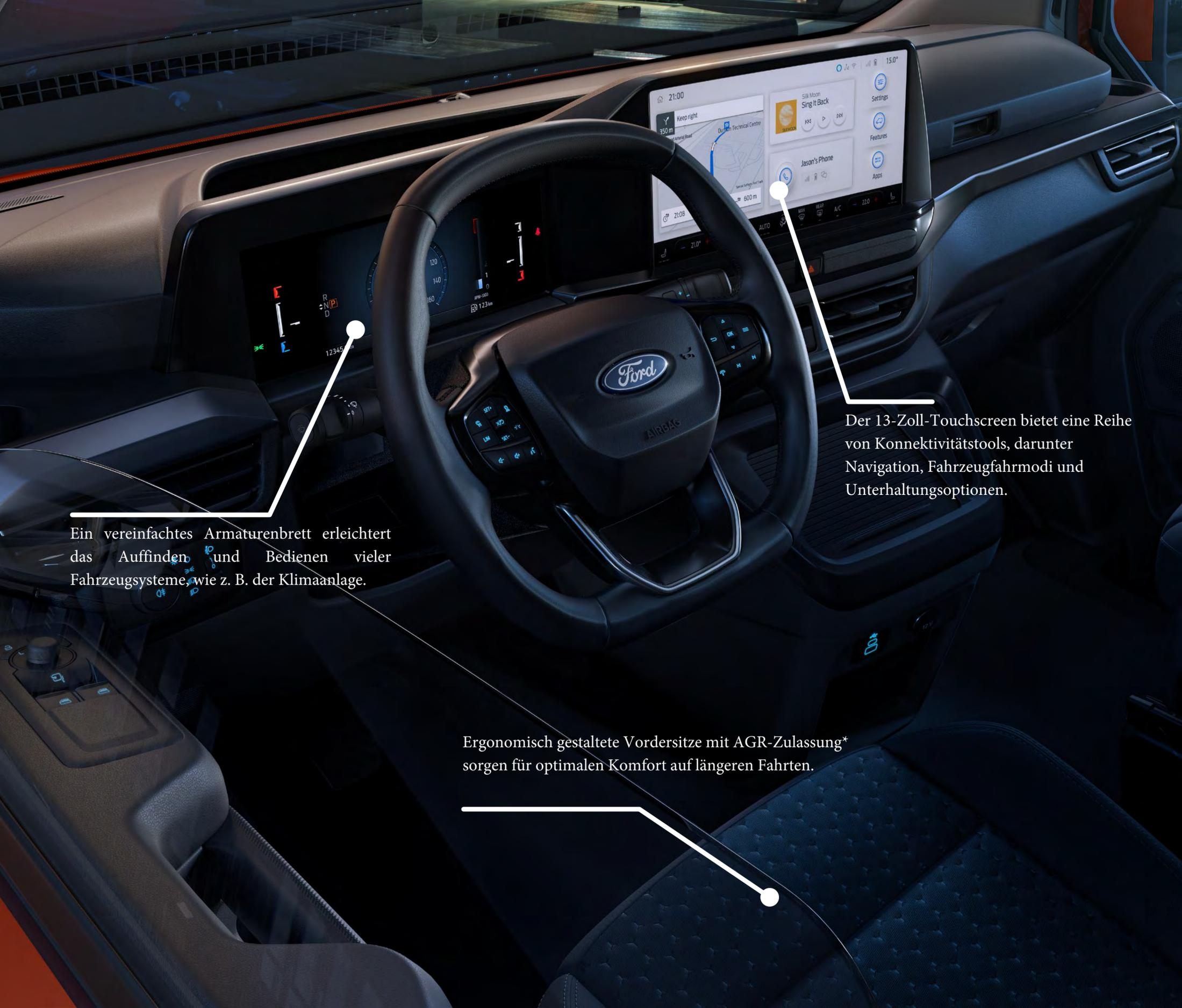
Ein vereinfachtes Armaturenbrett erleichtert das Auffinden und Bedienen vieler Fahrzeugsysteme, wie z. B. der Klimaanlage.
